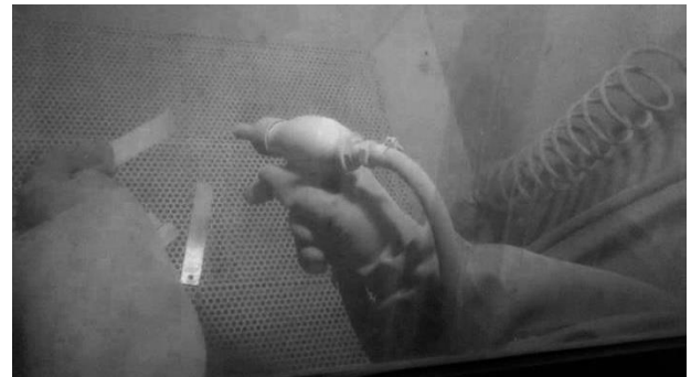
Fig. 2 – Processo de granalhagem.
