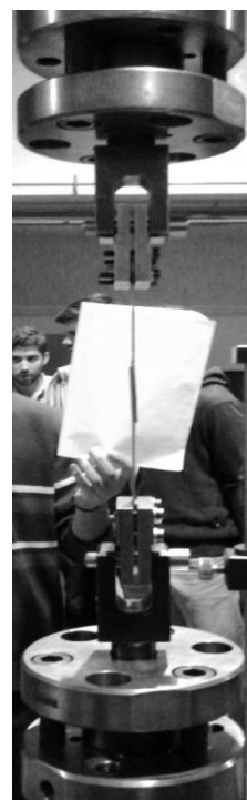
Fig. 8 – Ensaio de tração na máquina MTS. Note-se a rotação da junta devido ao momento fletor.
