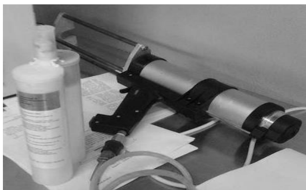
Fig. 5 – Reservatórios da mistura adesiva e pistola de aplicação.
