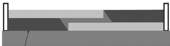
Calço (controla a espessura e o filete)
